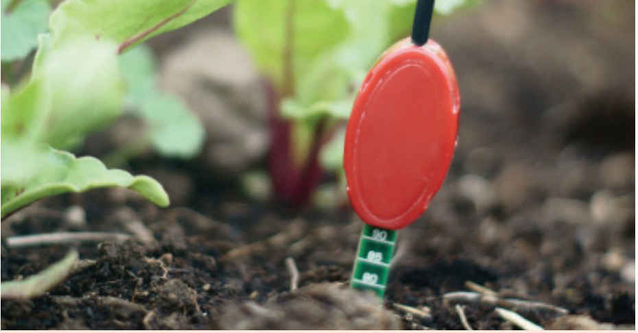
شكل (9): جهاز استشعار رطوبة التربة
